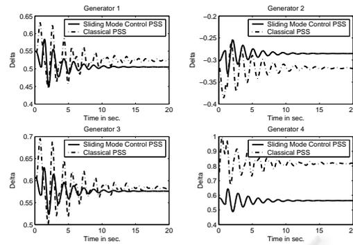
Figure 2: Nonlinear Simulation ( Rotor angle)
