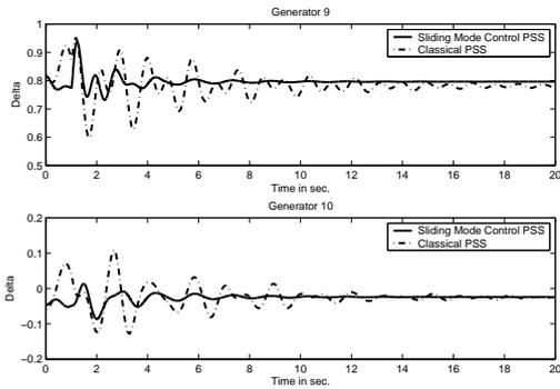
Figure 4: Nonlinear Simulation ( Rotor angle)
