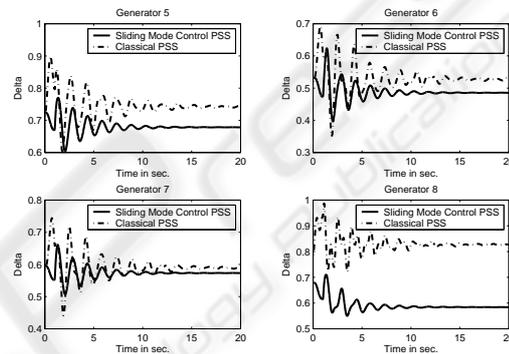
Figure 3: Nonlinear Simulation ( Rotor angle)
